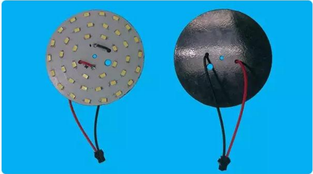
图二，20W石墨烯LED光引擎
