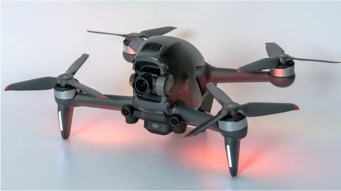
图 12 机身前侧为了增强机臂的坚固性和抗风性，机臂采用固定式结构，不支持折叠，厚实的构造有利于应对意外撞击。机臂具有一定迎角，这一设计能够起到减少前飞阻力与增强刹车效果的作用。并且，机臂灯的色彩还支持修改，拥有多数无人机不具备的自定义空间。
